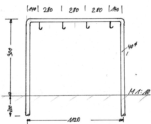
**aus 40 x 2 mm Messingrohr, Haken aus 6 x 30mm Flachmessing,**
